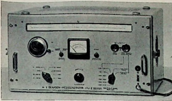
Klirrarmer Generator „SBF BN 40 861“ für sechs Frequenzdekaden zwischen 10 Hz und 10 MHz (Rhode & Schwarz)
